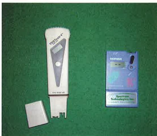
Figura 3 - Aparelho para medição de condutividade elétrica (condutivímetro) e cartela para determinação rápida da concentração iônica
