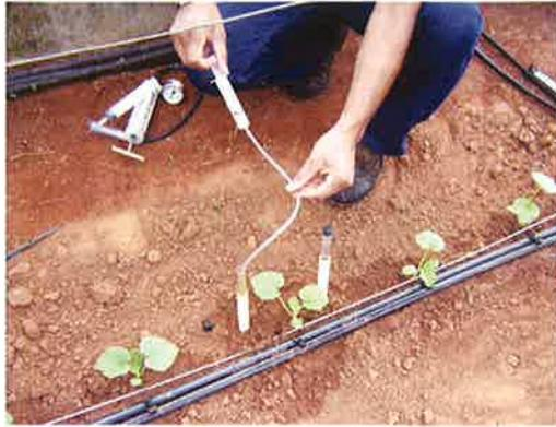
Figura 4 - Coleta da solução do solo com uso de um microtubo e uma seringa descartável
