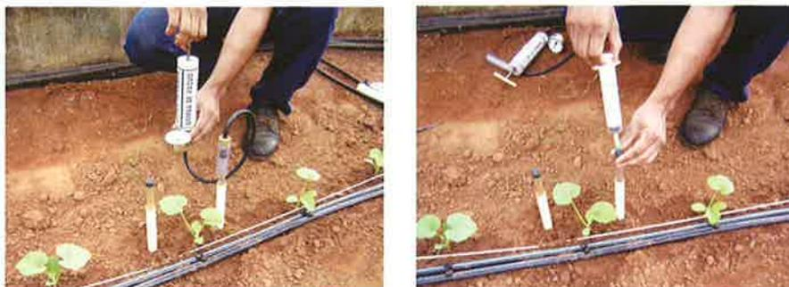
Figura 2 - Eliminação do ar no interior do extrator com bomba de sucção (A) e com seringas descartáveis (B)
